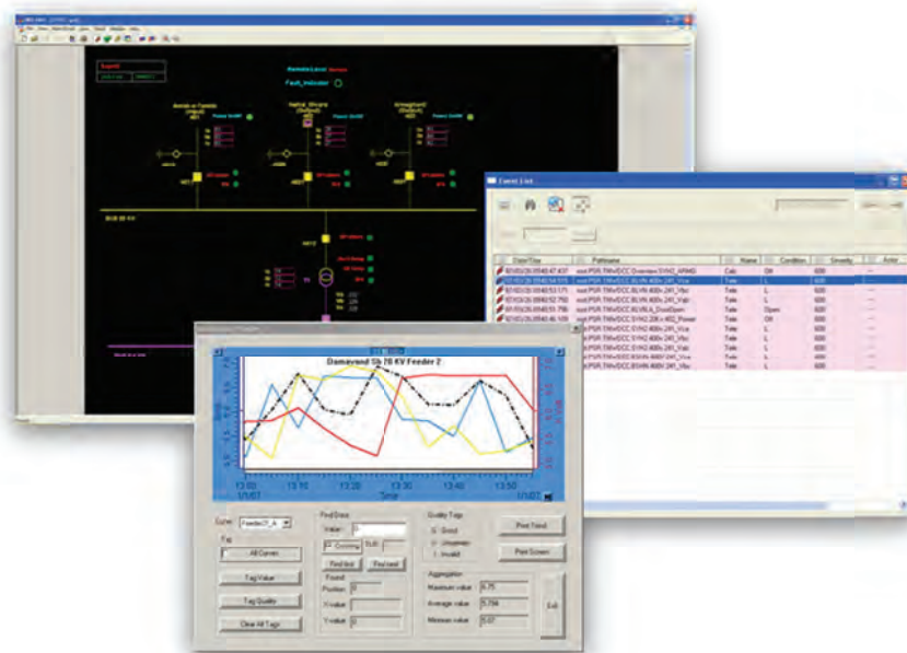
پنجره‌های نقشه تک خطی، لیست هشدارها و ترسیم کننده منحنی در NRI-SCADA
