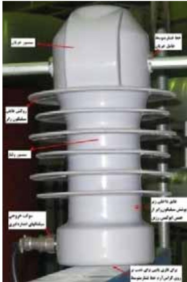
مقره سنجش ولتاژ و جریان با معرفی اجزای آن
