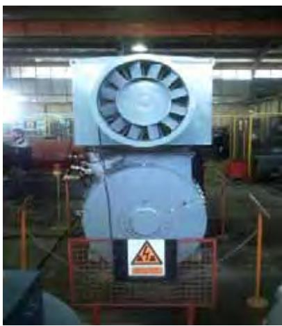
الکتروموتور ۲۲۰۰ کیلووات طراحی و ساخته شده در شرکت توربوژنراتور
