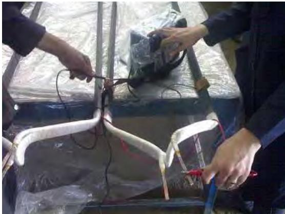
تست مقاومت عایقی کویل‌های استاتور پیش از نصب
