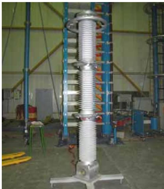
تصویر ترانسفورماتور نوری اندازه‌گیری ولتاژ پیزو-اپتیک برای پست‌های انتقال رده ۲۳۰ کیلو ولت
