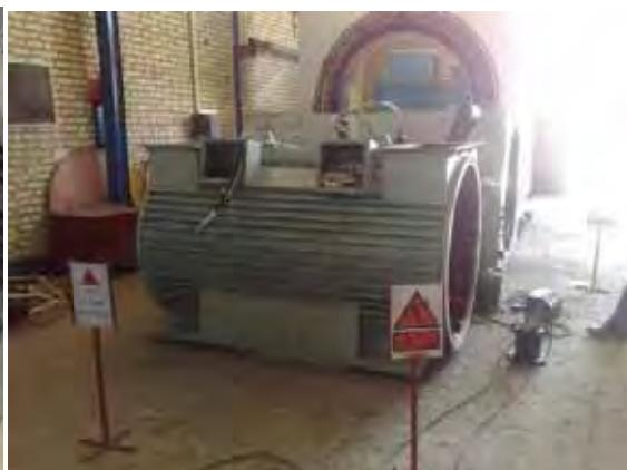
تست اضافه ولتاژ پس از نصب کویل‌های استاتور
