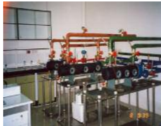
دستگاه تست عملکرد مبدل‌های حرارتی و نمونه دسته لوله‌های آزمایش شده در آزمایشگاه ترموهیدرولیک
