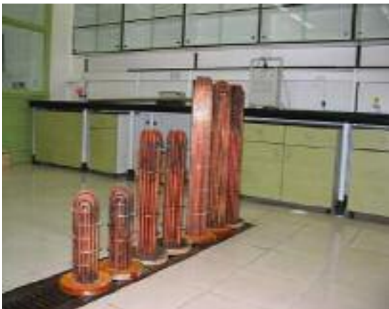
دستگاه تست عملکرد مبدل‌های حرارتی و نمونه دسته لوله‌های آزمایش شده در آزمایشگاه ترموهیدرولیک
