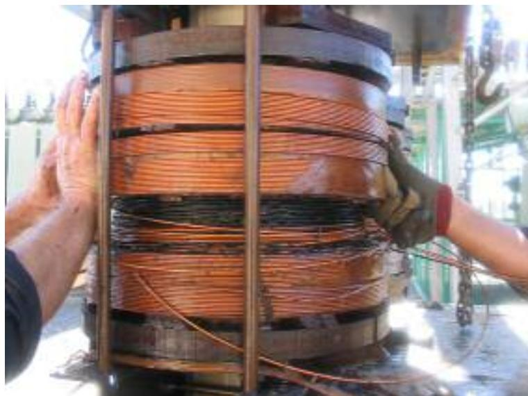
باتوجهه به تعدد حوادث منجر به سوختن ترانس‌های زمین در شرکت برق منطقه‌ای با ختر، در چارچوب یک قرارداد پژوهشی بین پژوهشگاه نیرو و این شرکت، مطالعاتی جهت مشخص نمودن عامل و یا عوامل تاثیرگذار در سوختن ترانس‌های زمین در سطح پست‌های فوق توزیع منطقه و نیز ارائه راهکار جهت حل مشکل، صورت گرفت که عمدۀ این فعالیت‌ها در ادامه آمده است.
