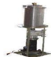
ویسکومتر جهت کنترل مصرف سوخت مایع نیروگاه ها
