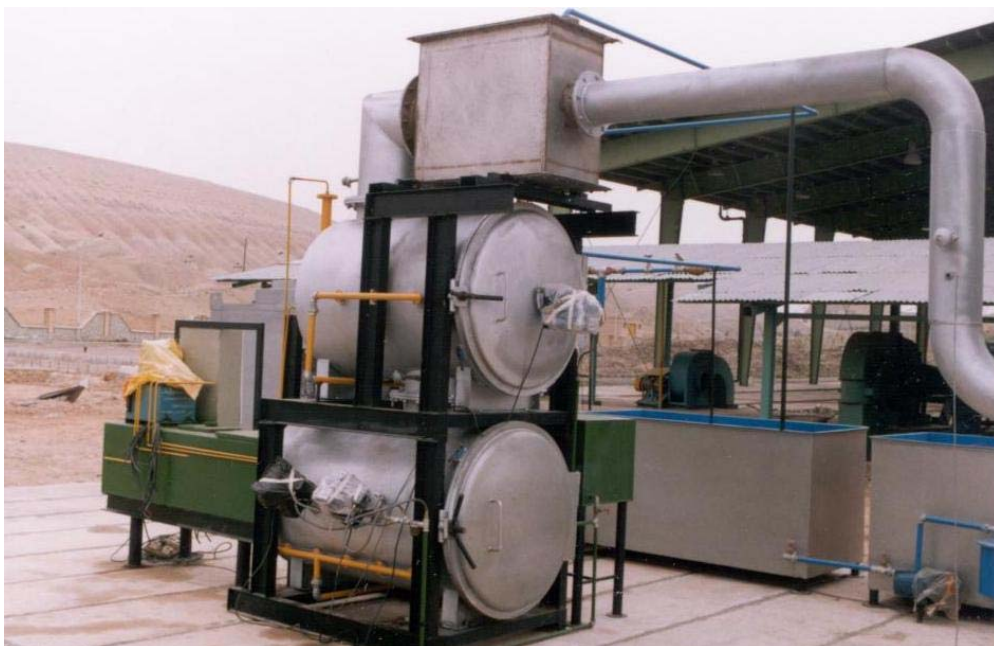
پایلو ت زیاله سوز نصب شده در کارخانه کمپوست کرج
