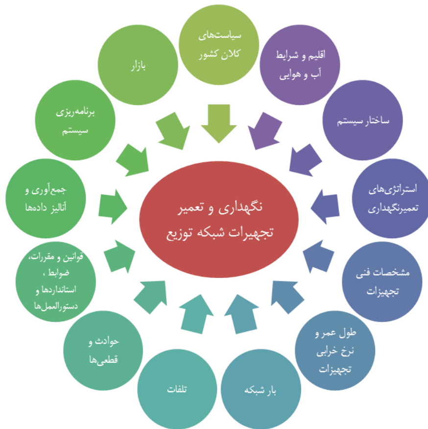
شکل (۷): عوامل تاثیرگذار بر نگهداری و تعمیر تجهیزات شبکه توزیع نیروی برق
