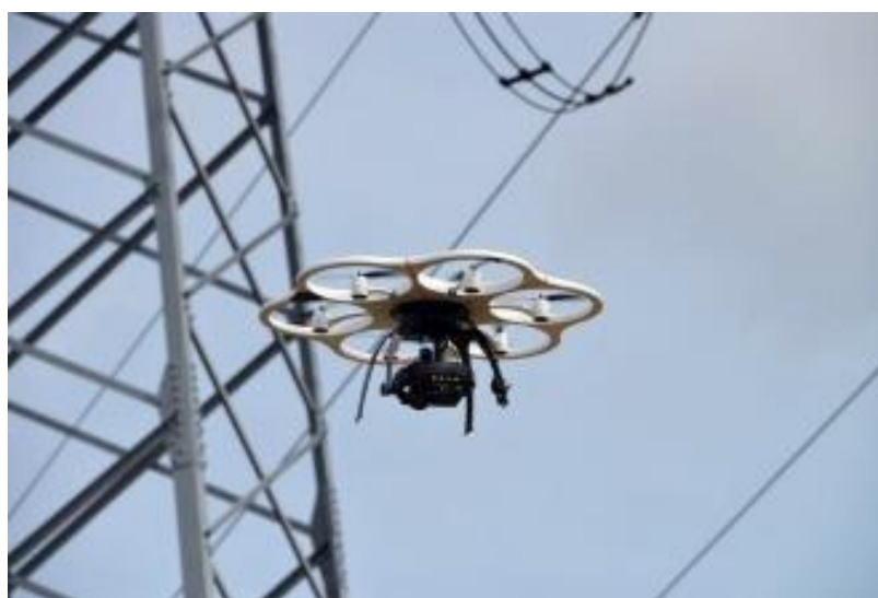
شکل (۵): تصویری از ربات پرنده‌ی بازرسی خطوط برق [۱۴]
