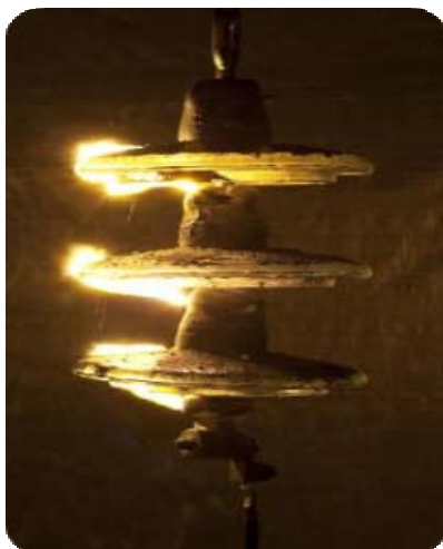
شکل (۱): نحوه نشت جریان و تخلیه الکتریکی در مقره
