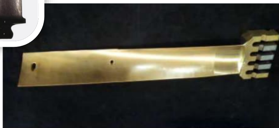
نمونه پره توربین بخار با پوشش Ti/TiN اعمال شده با روش PVD (به رنگ طلایی)
